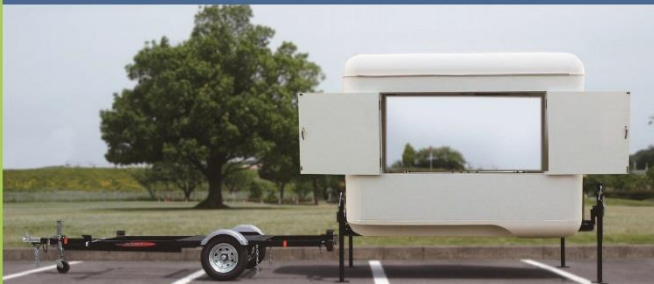
業界初のキャビンと車輪ユニットが簡単に脱着可能
